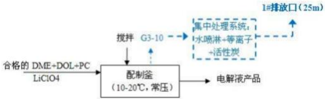
图 4.4-37 一次电池电解液的配制流程图
