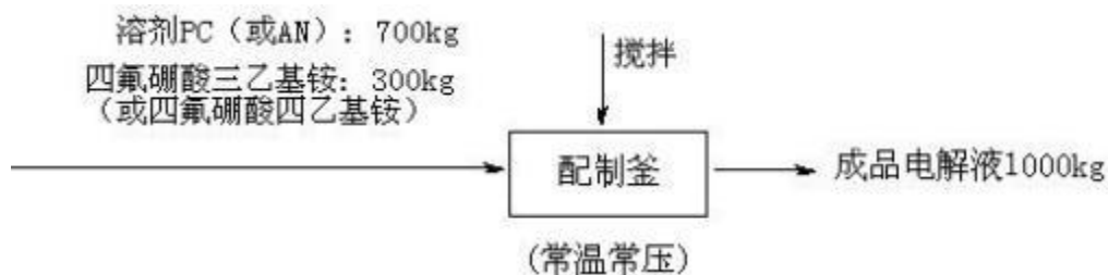
图 4.4-18 超级电容电解液配制工艺流程及物料平衡图
